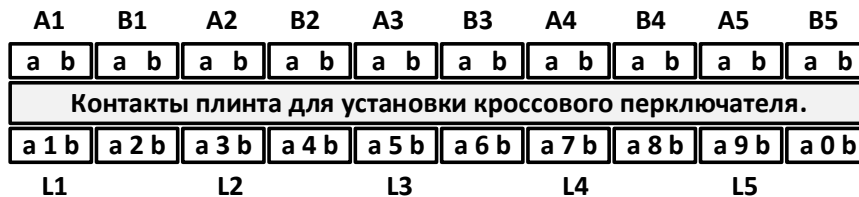
Рисунок 2. Схема коммутации Commeng LSW-P5
