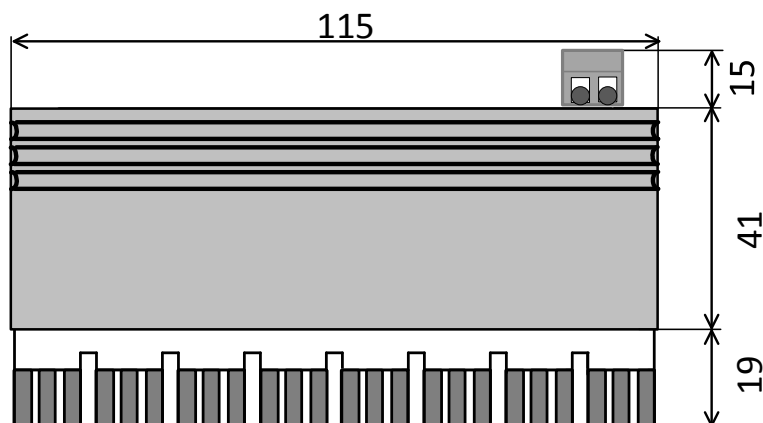
Рисунок 4. Габаритные размеры переключателя Commeng LSW-A4s
