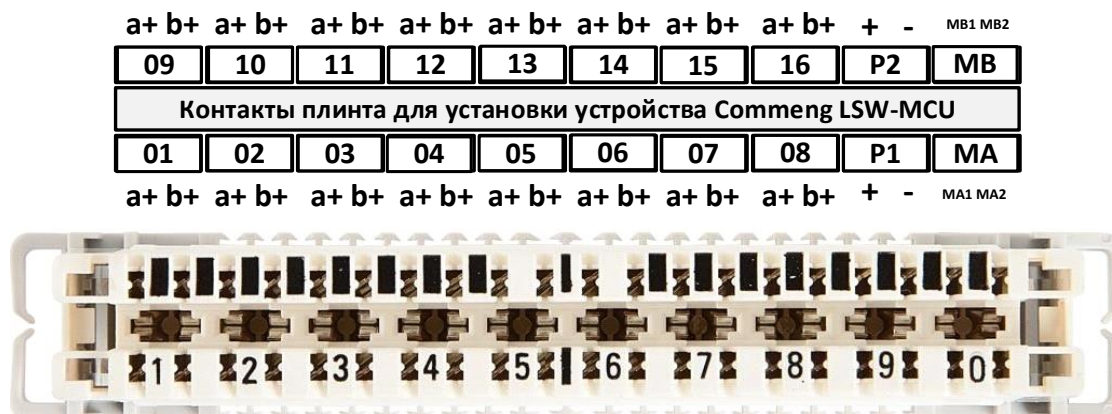
Рисунок 2. Подключение к контактам плинта цепей подачи управляющего напряжения, питания и мониторинга состояния
