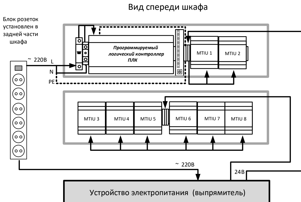
Рисунок 3. Пример расположения устройств управления коммутатора в 19" шкафу.
