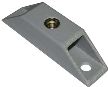
Рисунок 1. Внешний вид монтажного основания композитного МОК-ШЗУП-40/М8 (для шины шириной до 40 мм).
