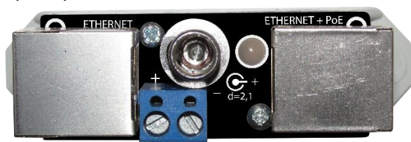
Рисунок 3. Лицевая панель инжектора Commeng PoET IS-B f/f
